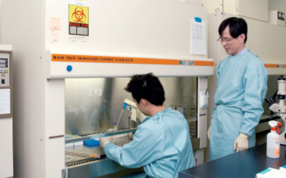
ウイルスを使った実験は、安全性が確保されたレベルP3実験室で行う。実験室内は外と比べて気圧が低く保たれており、室内の空気が外部に漏れない構造になっている
